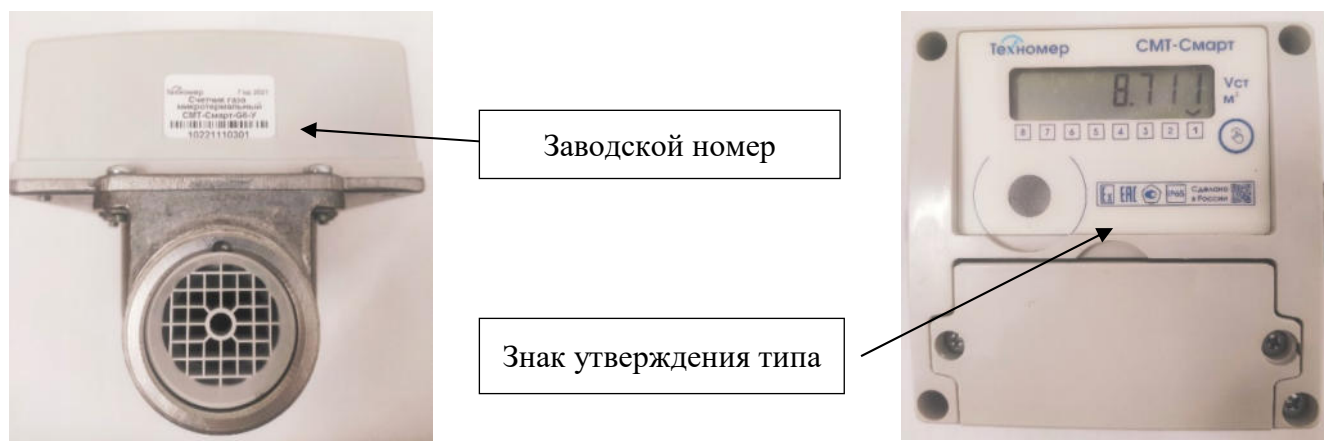
Рисунок 13 – Место нанесения заводского номера и знака утверждения типа
